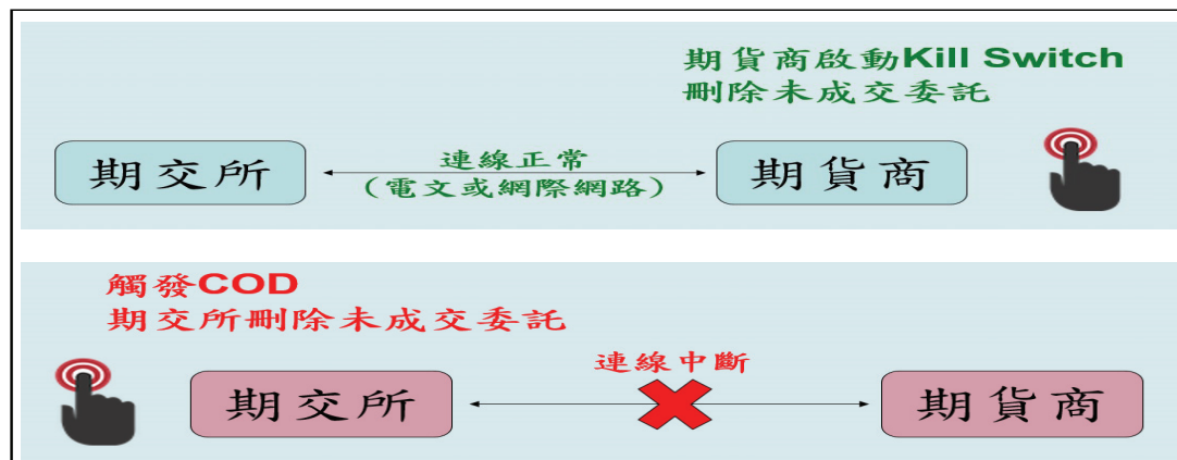
圖 2、Kill Switch 及 COD 運作示意圖
